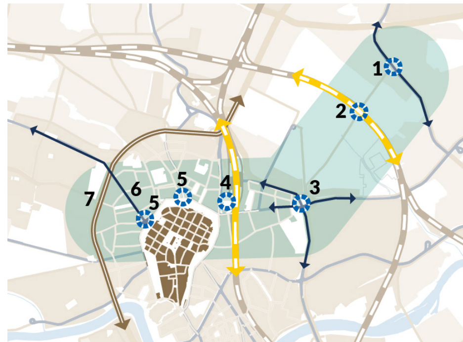
Rys. 6.10. Główne założenia trasowania odcinka centralnego.
